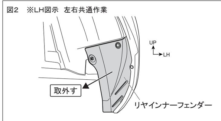
3. 図2のように該当車両の修理書に従い、車両からリヤインナーフェンダーを取外す。(左右各1箇所)
