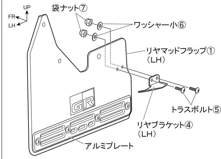
16. 図10のようにリヤマッドフラップ②(アルミプレート側)にリヤブラケット④をトラスボルト⑤、ワッシャー小⑥、袋ナット⑦で取付ける。(左右各1箇所)
