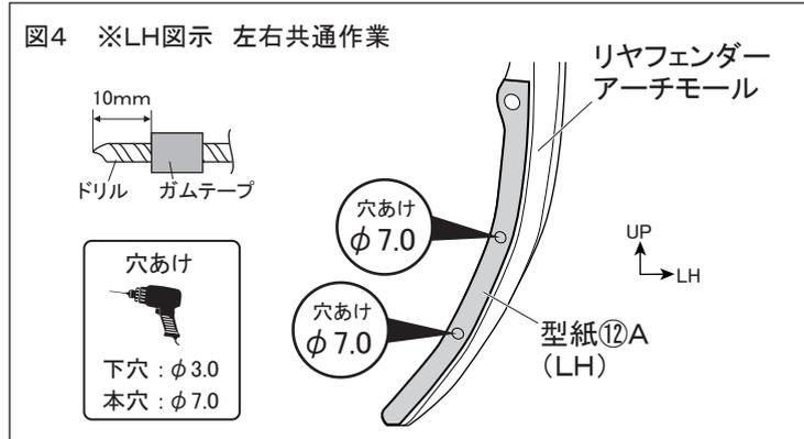
5. 図4のように型紙⑫Aの穴あけ位置に合わせて下穴をφ3.0であけ、φ7.0の本穴をあける。(左右各2箇所)
