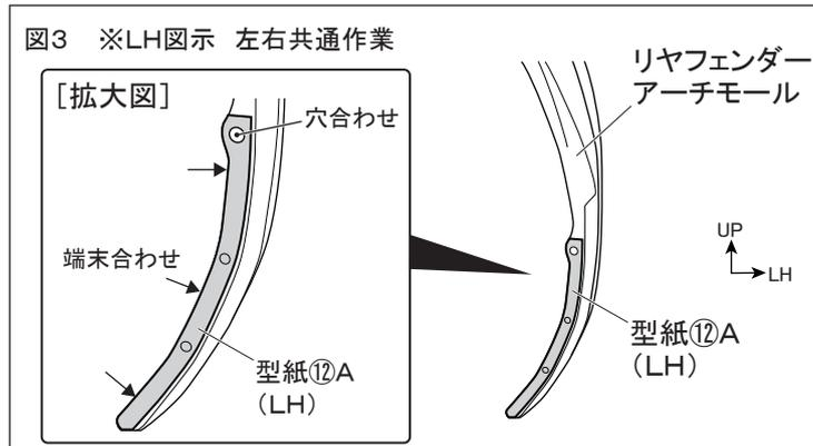
4. 図3のようにリヤフェンダーアーチモールのホイールハウス部に型紙⑫Aを貼り付ける。(左右各1箇所)
