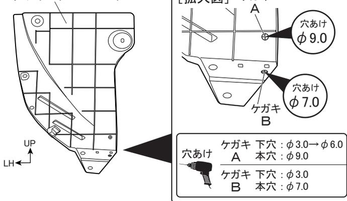
10. 図7のようにリヤインナーフェンダー後面のケガキ(A)に合わせて下穴をφ3.0→φ6.0の順であけ、φ9.0の本穴をあける。(左右各1箇所)
