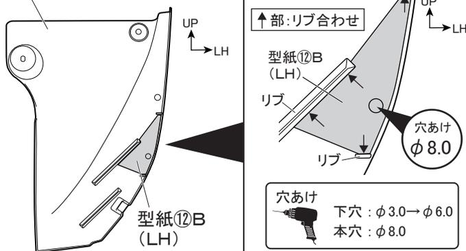
8. 図6のようにリヤインナーフェンダーのリブ3箇所型紙⑫Bを貼り付け、穴あけ位置に合わせて下穴をφ3.0→φ6.0の順であけ、φ8.0の本穴をあける。(左右各1箇所)
