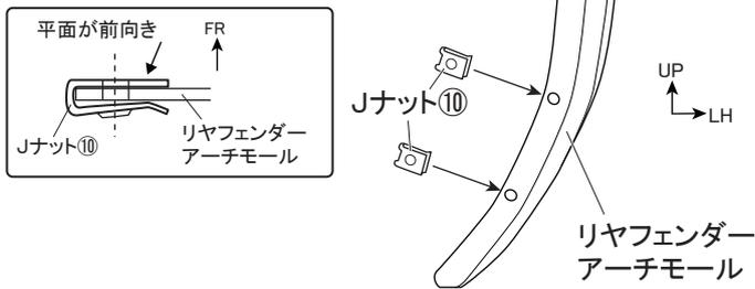
7. 図5のようにリヤフェンダーアーチモールの5.であけたφ7.0穴に合わせてJナット⑩を取付ける。(左右各2箇所)
