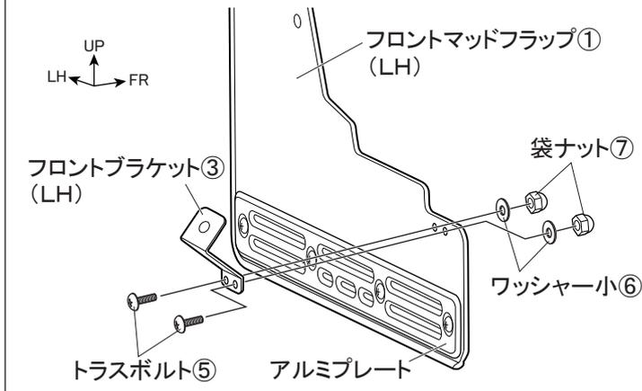
15. 図9のようにフロントマッドフラップ①(アルミプレート側)にフロントブラケット③をトラスボルト⑤、ワッシャー小⑥、袋ナット⑦で取付ける。(左右各1箇所)
