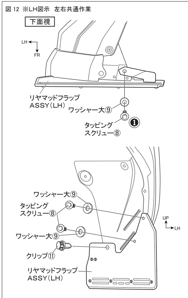
3. 図 12 のようにリヤマッドフラップASSYを車両リヤホイールハウス部にて、タッピングスクリュー⑧、ワッシャー大⑨(左右各3箇所)で仮締めし、クリップ⑪(左右各1箇所)を取付ける。
