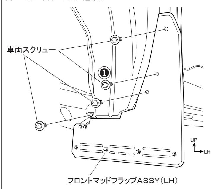
1. 図11のようにフロントマッドフラップASSYを車両フロントホイールハウス部にて、4ページ2.で取り外した車両スクリューを再使用して仮締めする。(左右各4箇所)
