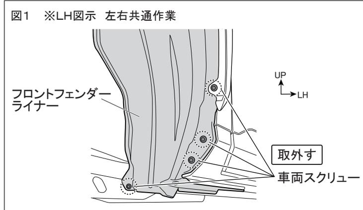
2. 図1のように車両フロントホイールハウス内のフロントフェンダーライナーを固定している図示車両スクリューを取外す。(左右各4箇所)
