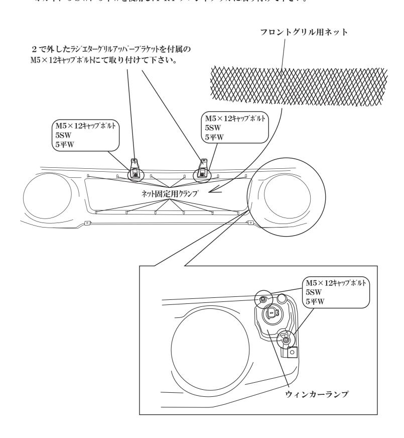
5 ラジエターアッパーシュラウドを外し、図を参考にウェルナットを車体に取り付けて下さい。
