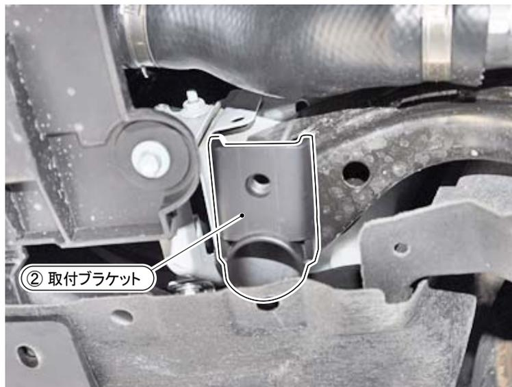
3. 左右の②取付ブラケットに①フロントパフォーマンスバー本体を合わせて、付属ネジ類で仮組みします。
