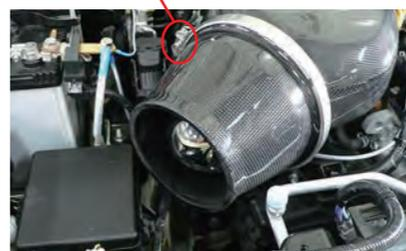
12. フィルターを入れて水抜き穴(GruppeM ロゴ)が下向きになる様にしてフィルターケースをVクランプを使用して取付けます。
