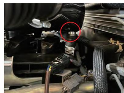
14. カーボンケースをサクシジョンホースに取付け、エンジンの上に配置します。後部にあるニップルをブローパイホースに差し込み固定します。
