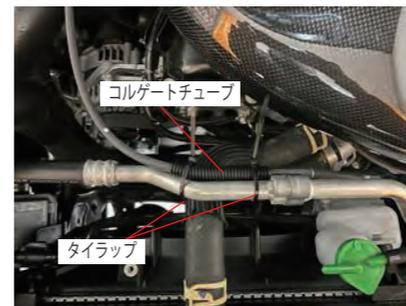
14. コルゲートチューブをバキュームホースに取付けて、エアコンの配管にタイラップx2で固定します。
