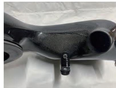
8. ステーx1をビスAx1でカーボンケースに取り付けます。カーボンケースに対して垂直に取付け、ステー穴の中心部で固定します。
