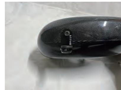
9. ステーx1をビスAx1でカーボンケースに取り付けます。カーボンケースに対して垂直に取付け、ステー穴の中心部で固定します。
