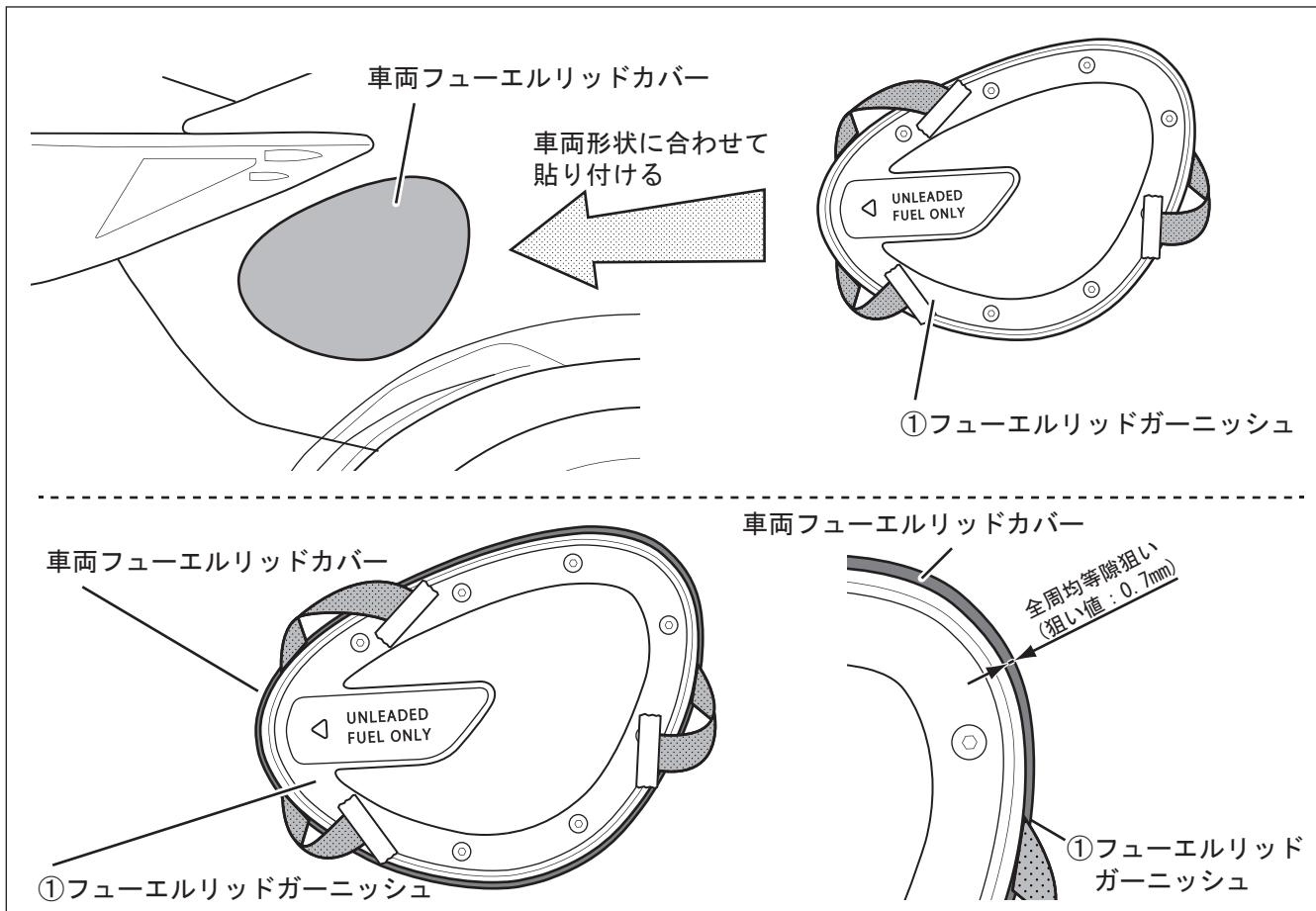
9. 離型紙の残りを、矢印方向へ①→③の順番で、ゆっくり引き抜きしっかりと圧着します。
