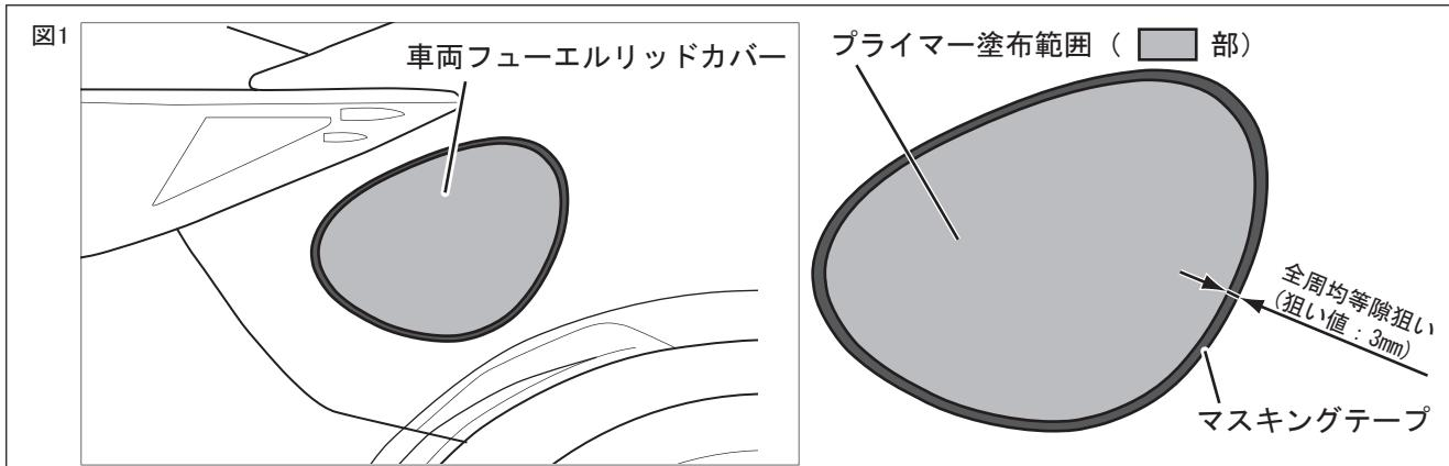
4. 下図を参考に①フューエルリッドガーニッシュの両面テープの離型紙を矢印の方向に少し剥がし、製品形状に合わせてマスキングテープ等で意匠面側に貼り付ける。(全3箇所)
